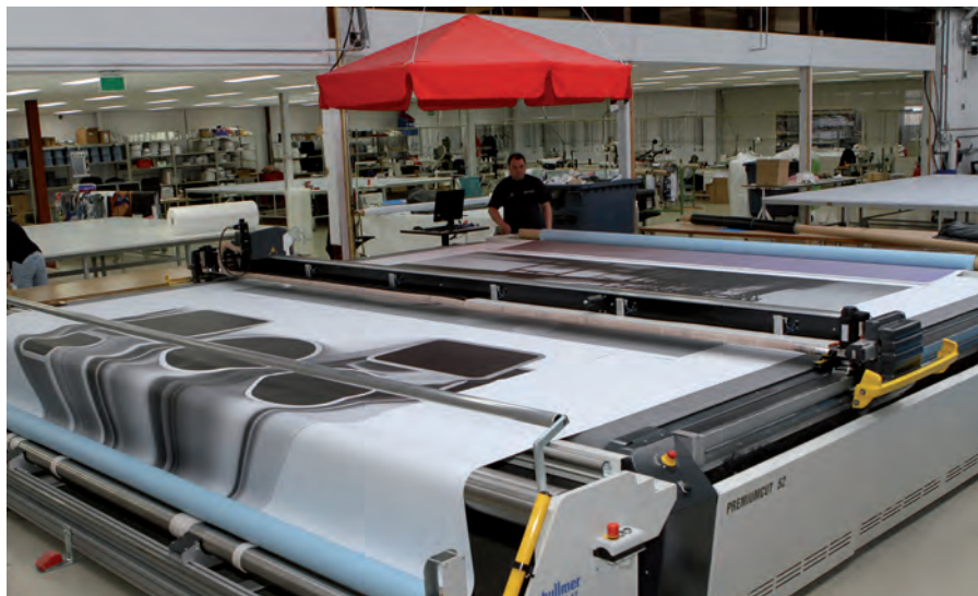
Er is al bijna een jaar ervaring opgedaan met een 5 meter brede snijtafel van Bullmer die inmiddels volledig in de workflow is geïntegreerd.
