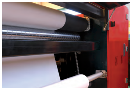
Automatisch stofdoorvoersysteem; rechts een doorvoerketting zichtbaar.
