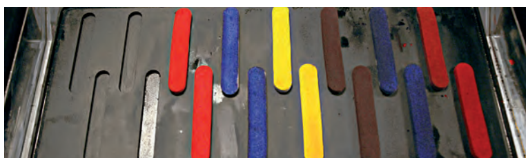
Parkeerstation printkoppen; per kleur twee Konica Minolta 1024i koppen.
