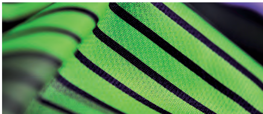
Sublimatietransfers op groot formaat, in zeefdruk vervaardigd en gefixeerd op polyester kleding op rol.
