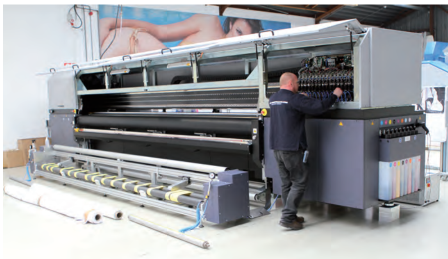
Op dit moment draait de Durst Rhotex 500 sublimatieprinter bij Van Straaten nog op 3,2 meter, omdat de 5 meter brede Klieverik kalender medio april arriveert.
