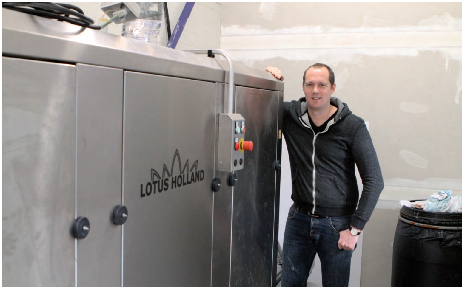
Jochem van der Mijl van Eco Textieldruk bij het Lotus Evo systeem, waarin zeefdrukramen automatisch worden gereinigd, ontvet, gestript, nagespoeld en gedroogd
